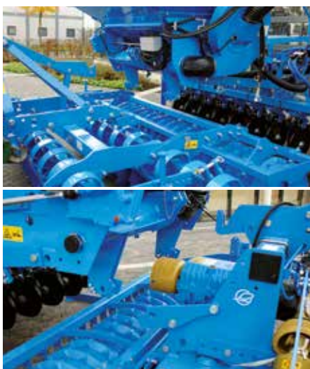
A Heliodor rövidtárcsán (fent) és a Zirkon forgóboronán (lent) lévő univerzális csatlakozás biztosítja azt, hogy a vetőgépet gyorsan át lehet szerelni az egyik talajművelő-eszközzel a másikra.
